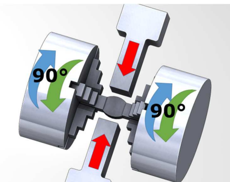
Rys. 39. Schematyczne przedstawienie procesu ściskania wieloosiowego w systemie MaxStrain.
