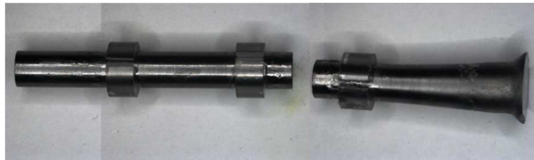
Rys. 79. Próbka do testu Taylora przed i po próbie.
