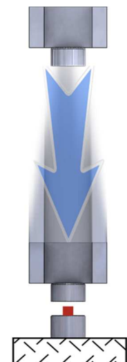
Rys. 59. Schematyczne przedstawienie zasady działania młota spadowego
